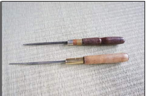
ヘリシキ ヘリを縫い付ける時に固定するのに使います。写真のものは20年使っているもので、指が当たるところがへこんでしまっています。
