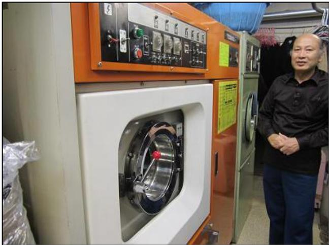
ドライクリーニングの洗濯機。一回に男性用のスーツ上下6着を同時に洗えます。
