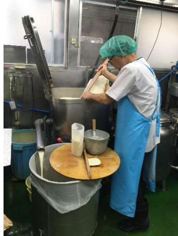
煮た大豆 だいず のペーストを布 ぬの に通 と してしぼると、パイプから豆乳 とうにゅう がでてきます。
